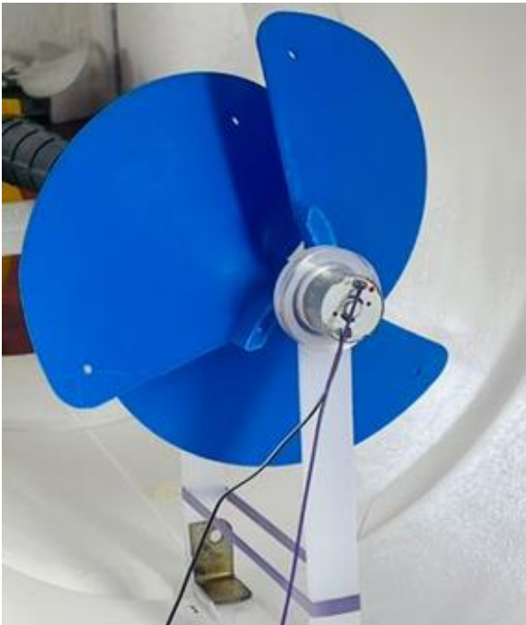
Figura 4. Turbina eólica tipo espiral de Arquímedes.
