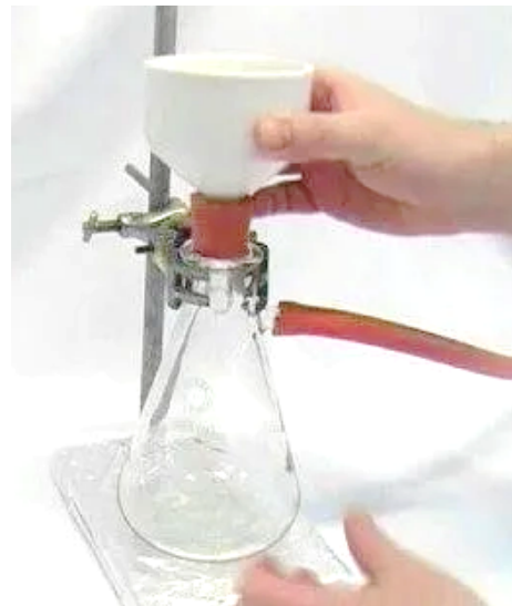
Figura 8. Filtrado del aceite.
