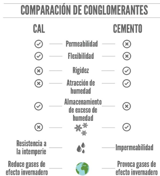
Fig. Fig. 6. INMATTERIA. (2014). Ilustración comparación entre aglomerantes.
