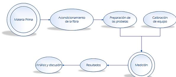
**Figura 1.** Diagrama de flujo para la medición de la fibra de abacá
